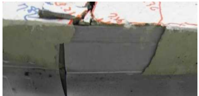
그림 9. 슬래브 두께 200mm 실험체의 데크플레이트 파단
