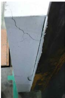
사진 4. P-RC-13W*6-1 실험체의 파괴양상
