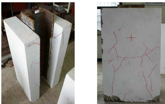
사진 2. P-RC-13*4-3 실험체의 파괴양상
