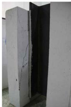
사진 5. P-VRC-13W*6-2 실험체의 파괴양상
