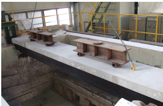
그림 8. 하중재하 전 실험체 형상 및 노 내부 전경
