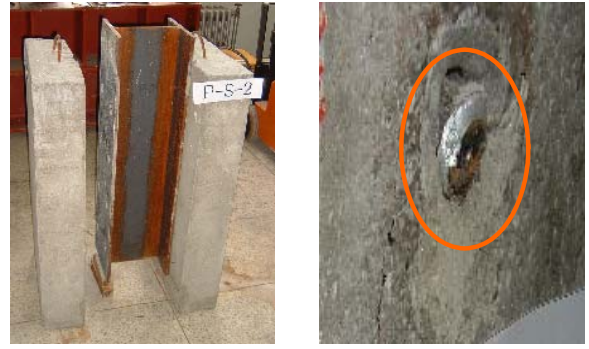
(a) 실험 종료 후 전경 (b) 스테드 전단파단 그림 5. P-S 시리즈 실험체의 파괴양상
