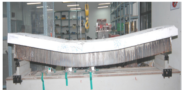
사진 2. T4.4-H25-N-S20 실험체의 가력 종료 후 파괴양상
