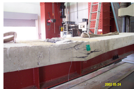
사진 2. 상부 슬래브의 콘크리트 파괴
