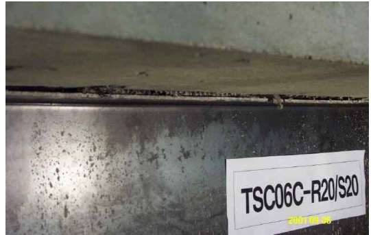
그림 11. TSC06C-R20S20실험체의 수평전단파괴 성상
