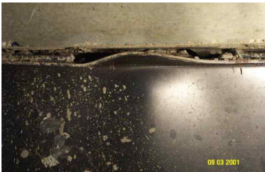
그림 10. TSC12C-R20S20실험체의 수평전단파괴 성상
