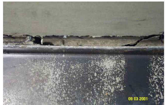
그림 12. TS812C-R20S20실험체의 수평전단파괴 성상
