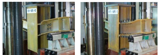
그림 4. 표준약축접합부 및 신형상 약축접합부의 파괴형상
