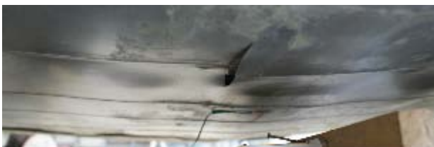
그림 5. 하부의 0.5mm 거푸집용 강판의 파괴상태
