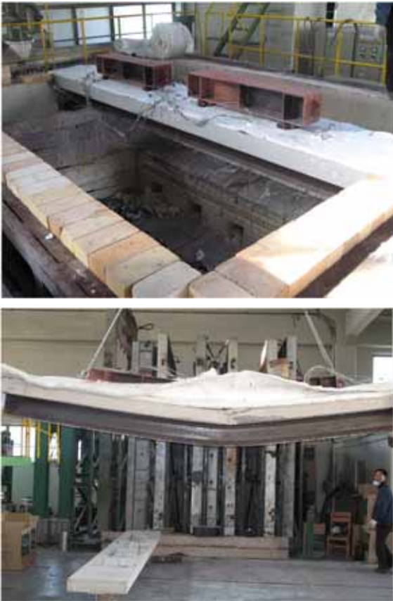
그림 5. 합성보 시험체의 가열실험 전후 모습
