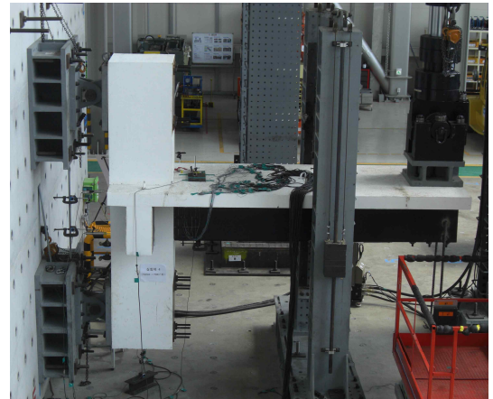
그림 3.1 PSRC와 TSC합성보 내진접합부 실험
