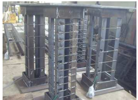
그림 3.5 PSRC기둥 압축강도 실험
